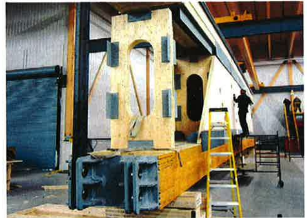
PHOTO FOURNIE PAR LES CHANTIERS CHIBOUGAMAU Un des trois caissons qui seront assemblés pour constituer l'une des deux poutres du pont, prêt à quitter l'usine pour Waswanipi.
